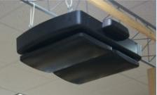
天井取付型RFIDアンテナ
